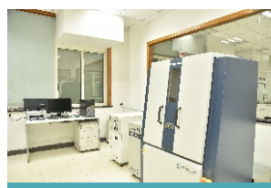
图：各贵重系列材料测试装备平台，可进行SEM形貌、EDS元素检测、XRD物相、TGA/DSC热稳定性分析以及电化学性能测试
